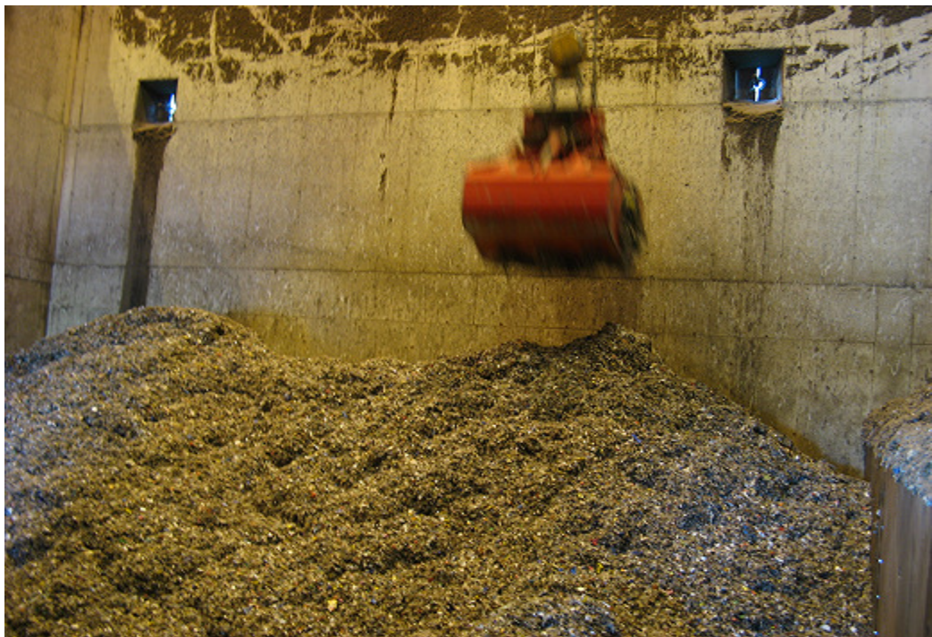
FIGURA 5-10 IL CDR PRONTO PER ESSERE CARICATO NEL FORNO A LETTO FLUIDO DELL'IMPIANTO DI BERGAMO
