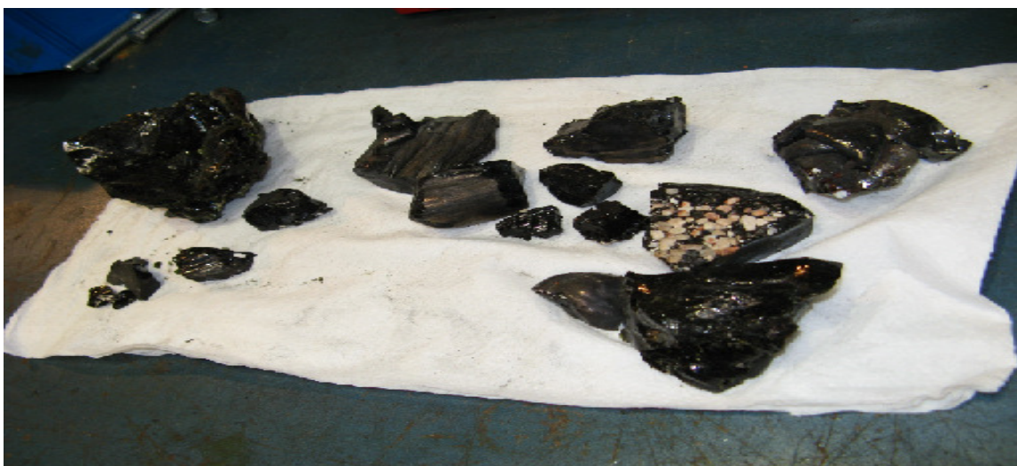
FIGURA 5-16 LE SCORIE VETRIFICATE PRODOTTE DALL'IMPIANTO PILOTA DI CASTELGALÌ,
