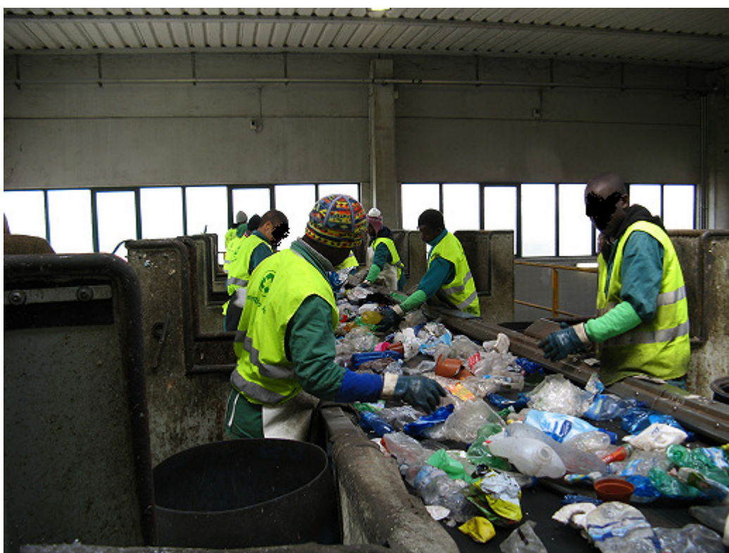
FIGURA 5-7 L'IMPIANTO DI SELEZIONE MANUALE DEI RIFIUTI DA RACCOLTA DIFFERENZIATA MULTIMATERIALE DEL CENTRO RICICLO VEDELAGO
